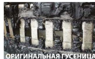
После 196 часов испытаний гусеницы конкурента вышли из строя, в то время как грунтозацепы Camso были в хорошем состоянии по всей окружности гусеницы.
